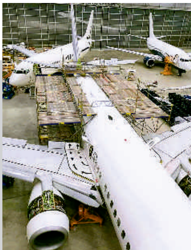
Obsługa techniczna samolotów - konstrukcja platformy roboczej, zaprojektowana przy użyciu elementów systemowych rusztowania modułowego Allround Layher
